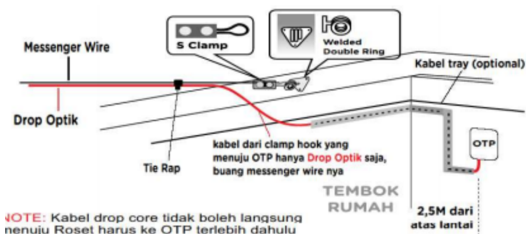
Gambar 3.36 Pemasangan Dropp Optik pada pelanggan
