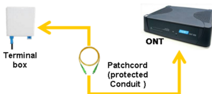
Gambar 3.37 Kabel Indoor berfungsi menghubungkan antar perangkat dalam gedung
