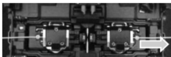
Gambar V.14. Tension Test dengan menekan tombol RESET
